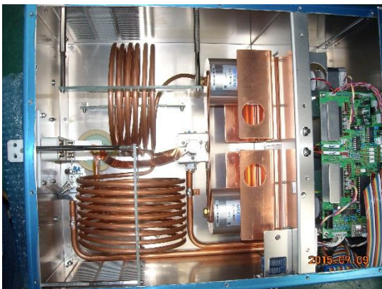
2MHz4MHzの2周波切り替え 式3kWの内部写真
