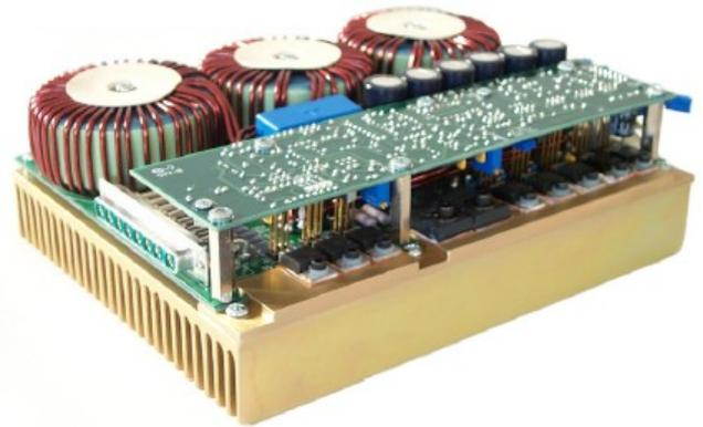
PCO-6131 は、ダイオードレーザ・バー・アレイを QCW 或いは CW モードで駆動するための、コンパクトな OEM スタイルの高電力パルス電流源です。電流範囲は 0~125A、パルス幅は<100ns~DC、パルス繰返し周波数はシングルショット~500KHz、デューティサイクルは最大 100%です。
