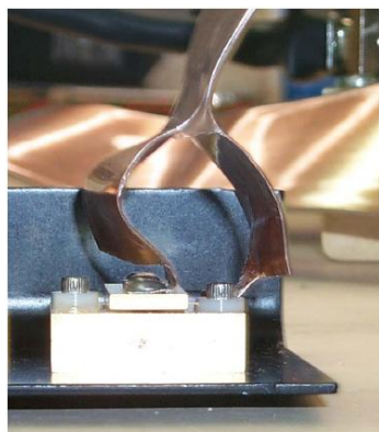
<図4 (左)、図5 (右) : ストリップラインケーブルでレーザダイオードに接続>
