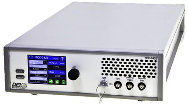
PCX-7420 は CW/QCW 電流源として、レーザダイオード/バー/アレイを駆動するように設計された空冷のハイパワー電源です。出力パルス電流値は 0.05A~21.5A で可変、パルス幅は 50ns~500ms、立ち上がり時間は<math>< 25\text{ ns}</math>、パルス繰返し周波数は内部トリガで 40~100kHz、外部トリガではシングルショット~1MHz までの電流パルスを出力します。
