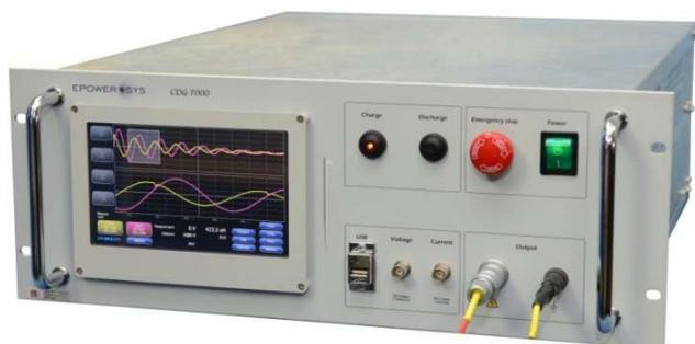
EPOWERSYS CDGシリーズは下記の巻線絶縁欠陥を検出するために設計されたコイルテスターです。
