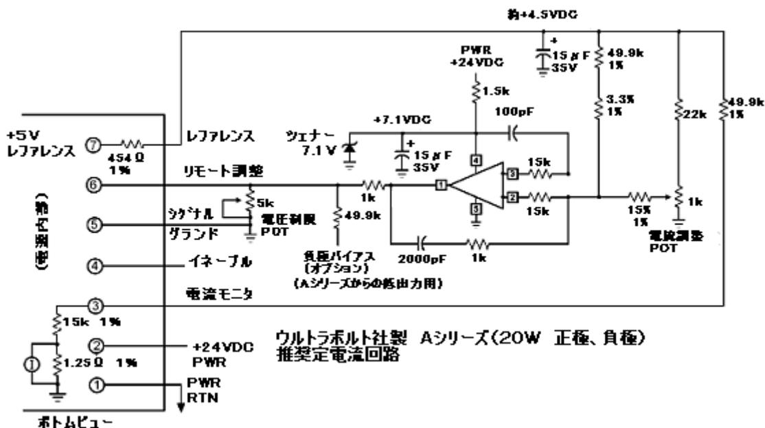
注1: 所定の電流制限点の設定に使用できる電流調整用半固定抵抗があります。この回路は、P(正)またはN(負)の高圧電源 のどちらでも動作します。ここに示す提案回路では+24V電源入力が仮定されています。49.9K および22K 抵抗器の下方調整により、回路は+12V パスまで動作できます。
