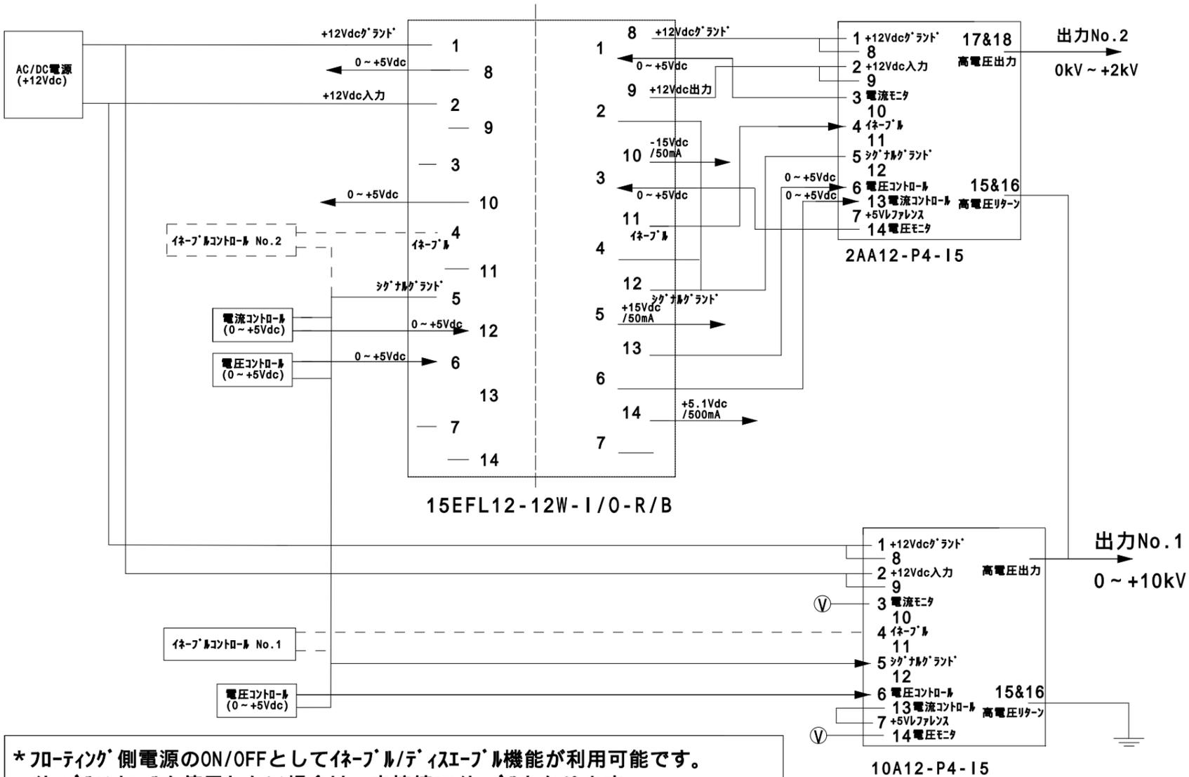
\* フローティング側電源のON/OFFとしてインバーブル/デイスイェブル機能が利用可能です。
