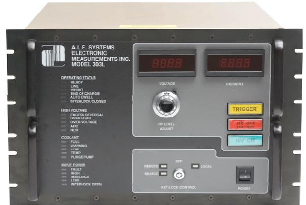
303 シリーズは 1 筐体としては最大の 30kJ/s 平均を出力するキャパシタ充電用定電流(CC)電源で、高電圧キャパシタやパルスフォーミングネットワーク (PFNs) を充電します。また定電圧(CV)電源として、連続直流出力 50kW を供給する電源装置としても動作します。303 シリーズは各種レーザ、ハイパワーモジュレータ、電子ビーム、X 線、RF トランスミッタ、CW&パルスマグネトロンヒータリング、イオン注入等で使用されています。
