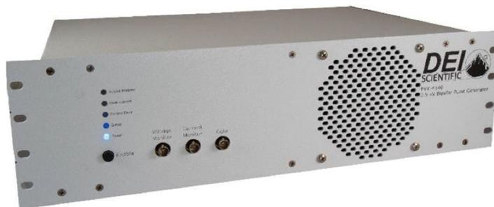
PVX-4141 パルスジェネレータは、3,500V までの高速高電圧パルス波形を発生させます。PVX-4141 は高インピーダンスの容量性負荷の駆動用に設計されており、飛行時間型質量分析装置 (TOF-MASS) や加速器において、粒子ビームの静電変調のための抽出グリッドや偏向板のドライブに最適です。丈夫で多用途に合わせた設計であるため電力用真空管・ポッケルスセルや Q スイッチ・アコースティックトランスデューサ・マイクロチャンネルプレート・フォトマル・イメージンテンシファイアのパルス化やゲートにも最適です。他に類を見ない高品質なパルス波形により、PVX-4141 はシステムの性能を最適化します。
