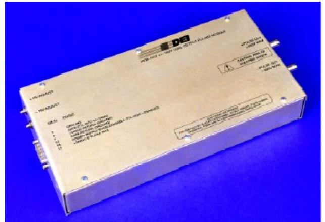
PVM-4210 はコンパクトな OEM 向けパルスジェネレータモジュールで、最大±950V (1,900V 差動出力) の差動電圧パルスを同時に出力します。パルスの立上り/立下り時間は 15ns 未満で、パルス幅は DC~<40ns を連続的に調整できます。このパルスジェネレータは+24VDC~+28VDC で動作し、高電圧直流電源を内蔵しています。
